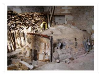
Anagama ou four Dragon, originaire d'extrême orient, destiné à la production de poterie usuelle, à demi enterré dans une pente. Ce four est traversé d'un bout à l'autre par les flammes qui lèchent les pots disposés en escaliers. Le four peut atteindre des températures élevées (1350°-1400°c)
